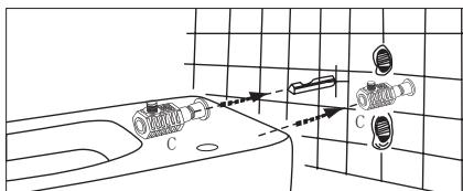
5. D installeren in het schroefgat van C & bevestig het op het montagegat met behulp van A.
